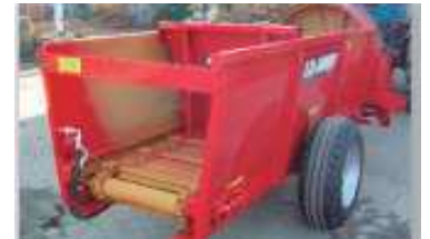
PUERTA TRASERA QUE AVANZA EMPUJANDO ESTIÉRCOL A LA TURBINA MOVIDA POR CADENAS, PARA ESTIÉRCOL MUY HÚMEDO
